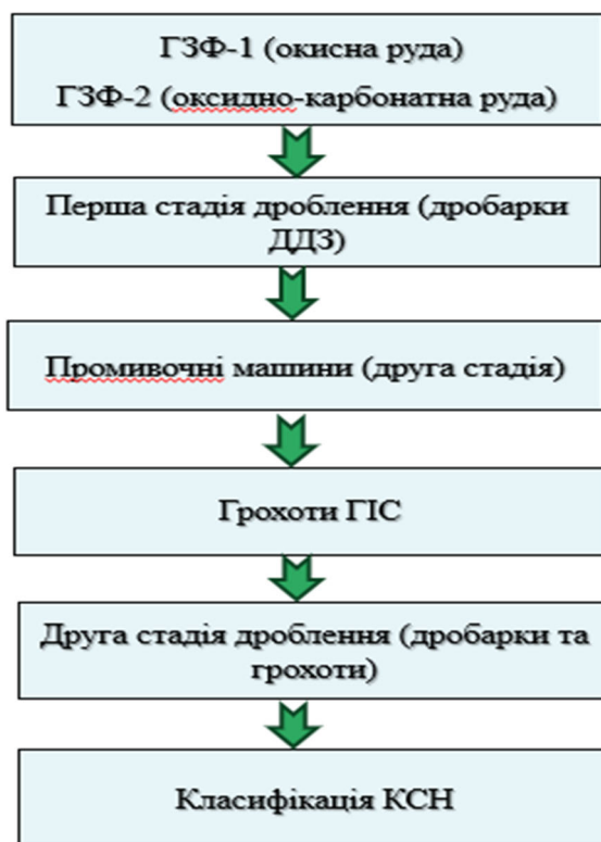
Рис. 16.1 - Блок -схема виробничого процесу збагачування марганцевих руд
