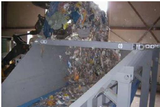
Накопичувальний стрічковий конвеєр (над підлогою)
