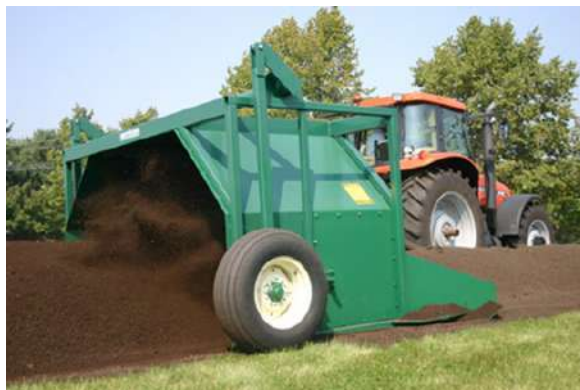
Тракторний самохідний перевертач
