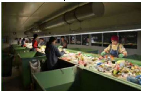
Станція для ручного сортування
