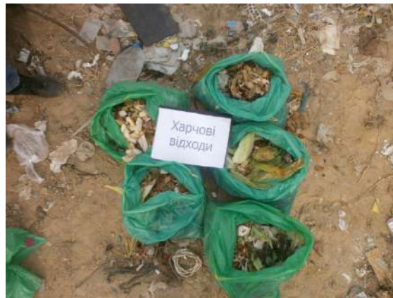
Рис. 2.2.1.1 Розбирання сортувальниками представницьких проб, зважування компонентів, фіксація результатів
