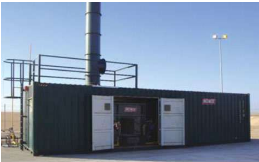
Рисунок д.11.3. Контейнерна сміттєспалювальна установка
