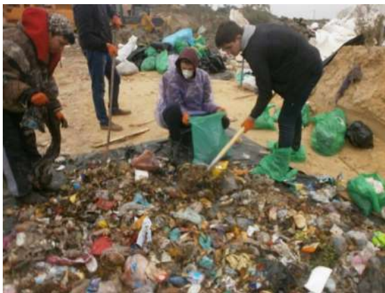
Рис. 2.2.1.1 Розбирання сортувальниками представницьких проб, зважування компонентів, фіксація результатів
