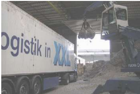
Транспортування сипучого RDF
